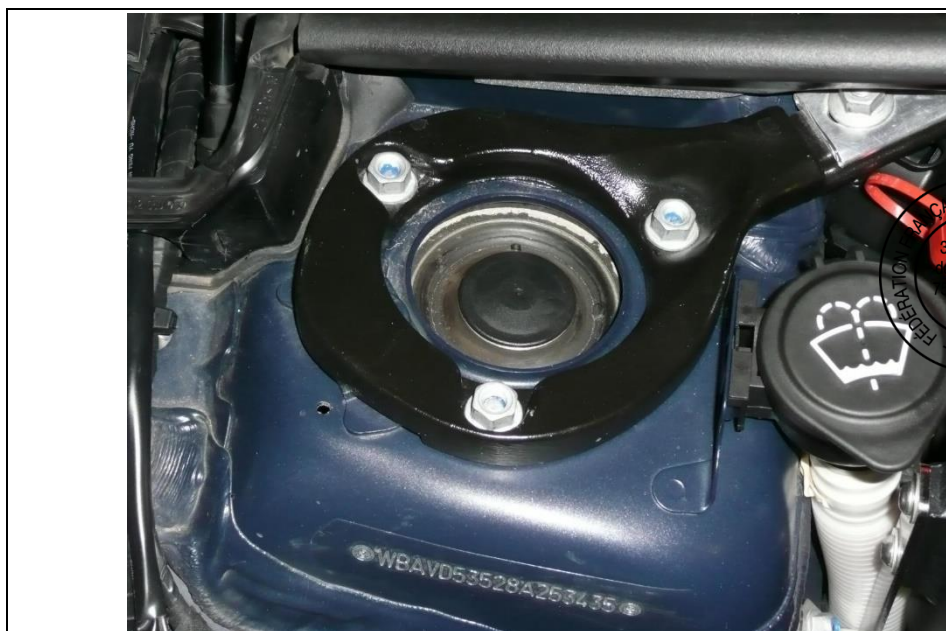
2.8. Point d'ancrage d'amortisseur avant d'origine de la voiture de série
