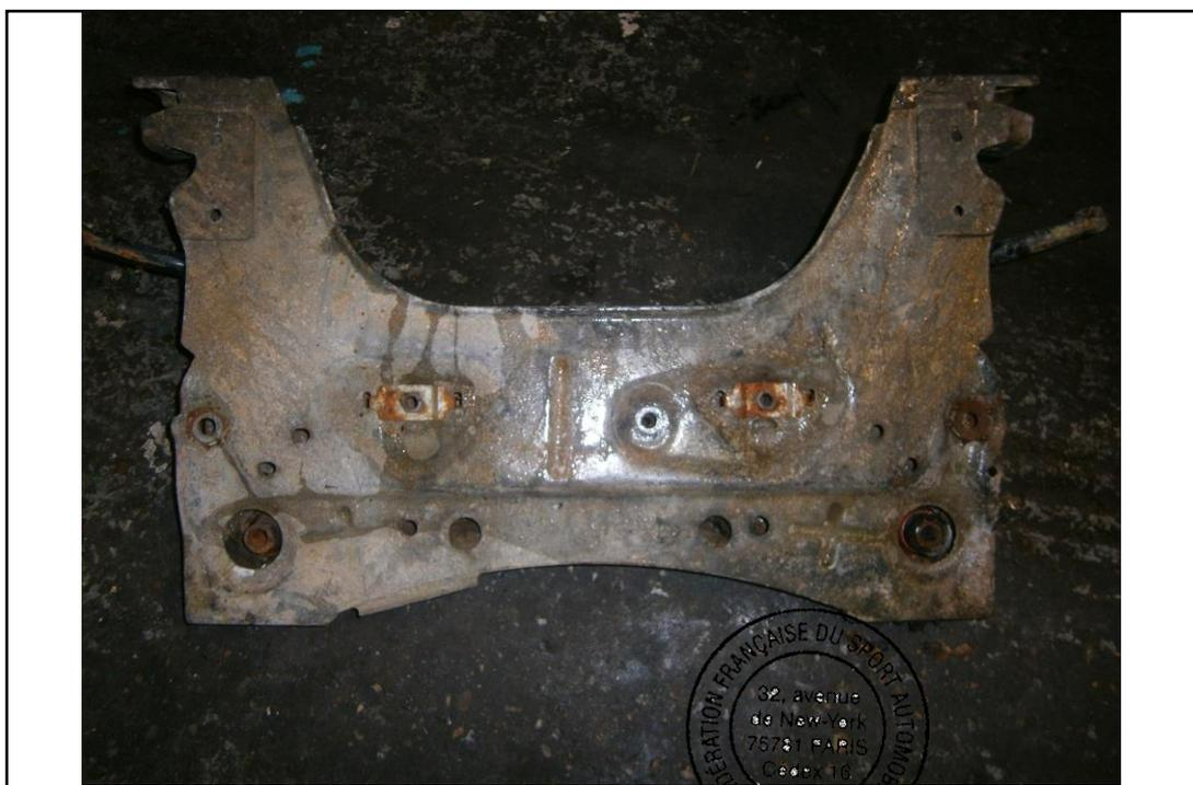
Point d'ancrage d'amortisseur avant d'origine de la voiture de série
